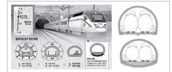
[그림 20] 인버트 미설치에 의한 터널 변형 리스크
