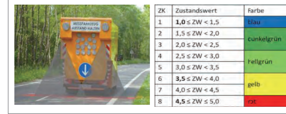
[그림 5] 차량 운행을 통한 데이터 수집(좌), 도로상태평가 등급(우)
