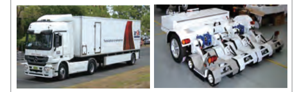
[그림 7] ARRB사 2세대 TSD장비(좌), 3D NM-GPR 트레일러(우)
